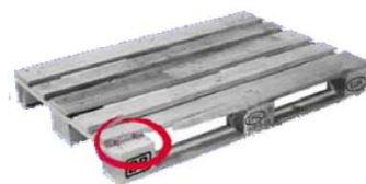
Ein Boden- oder Deckrandbrett ist so abgesplittert, dass mehr als ein Nagel- oder Schraubenschaft sichtbar ist.
