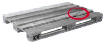
Mehr als zwei Boden- oder Deckrandbretter sind so abgesplittert, dass mehr als ein Nagel- oder Schraubenschaft sichtbar ist.
