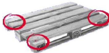
Ein Brett ist quer oder schräg gebrochen
