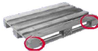
Ein Klotz ist Morsch, faul oder hat starke Absplitterungen.
