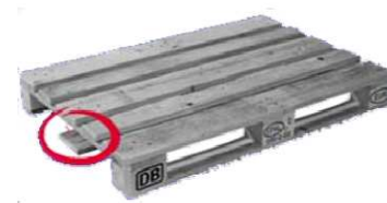
Ein Klotz fehlt oder ist so gespalten, dass mehr als ein Nagel sichtbar ist.
